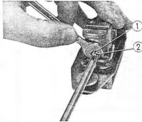
Fig. 8-12 ① Contre écrou de vis ② Vis de réglage
