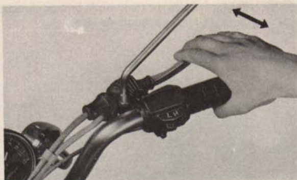
Fig. 4-30 Réglage automatique du frein avant
