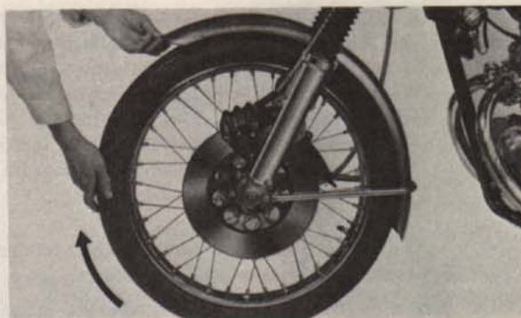
Fig. 4-31 Contrôle de frottement de la roue
