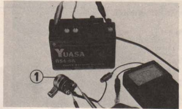
Fig. 3-109 (1) Relais magnétique du commutateur de démarrage
