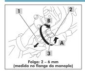
Para ajustar a folga, desloque o protetor de borracha (1), solte a contraporca (2) e gire o ajustador (3) na direção A para aumentar a folga e na direção B para diminuí-la. Reaperte a contraporca, reposicione o protetor de borracha e verifique novamente a folga.
