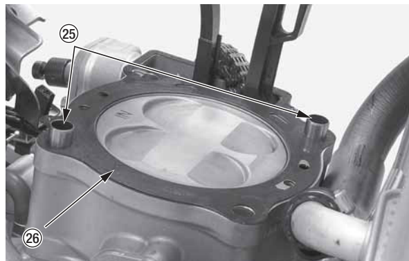
(25) установочные штифты (26) прокладка головки цилиндра
