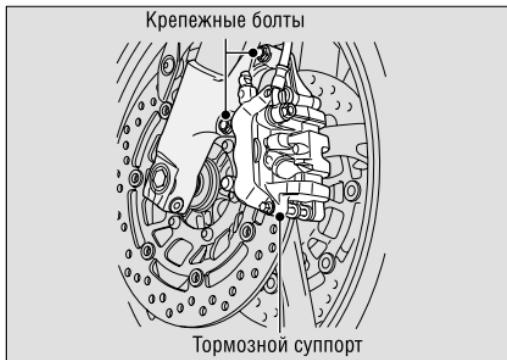
3. С левой стороны выверните крепежные болты и снимите тормозной суппорт.
