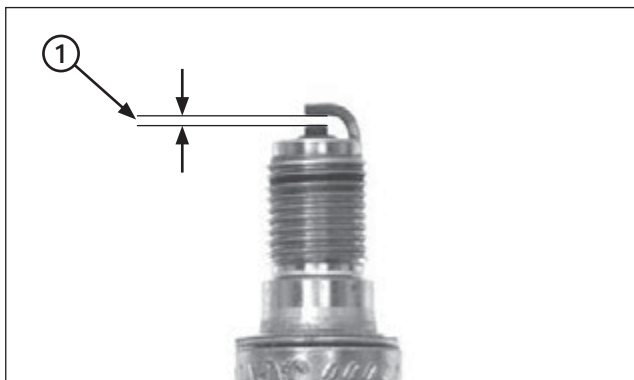
(1) ÉCARTEMENT DES ÉLECTRODES DE LA BOUGIE
