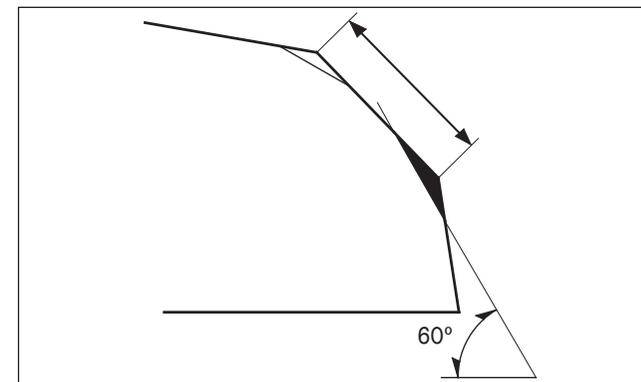
Utiliser une lame intérieure pour éliminer 1/4 du matériel du siège de soupape existant.
