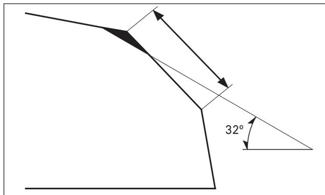
Utiliser une lame plate à 32° pour éliminer 1/4 du matériel du siège de soupape existant.
