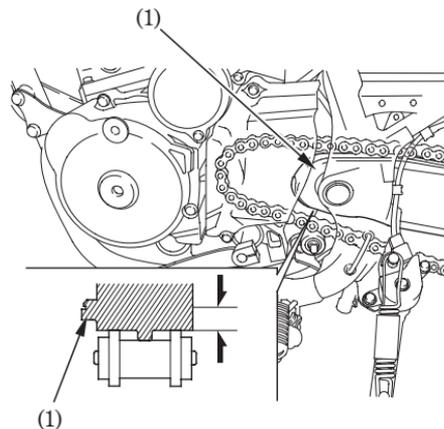
(1) Deslizador de la cadena de transmisión
