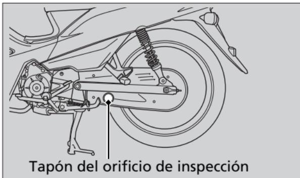
Tapón del orificio de inspección
